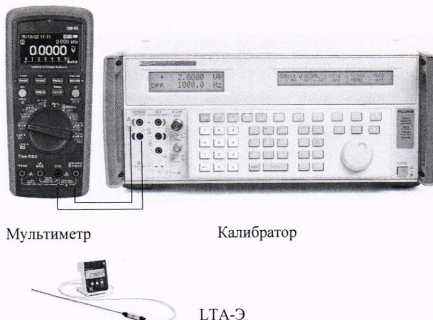
Рисунок 5 – Схема подключений для определения абсолютной основной погрешности измерений температуры с помощью преобразователей термоэлектрических (термопар) по ГОСТ Р 8.585-2001 (термопара типа К) (положение поворотного переключателя режимов работы мультиметра показано условно)
