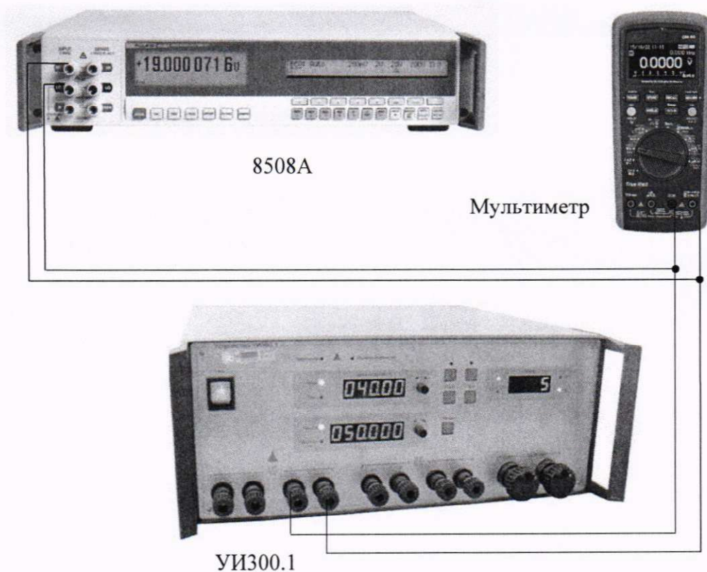
Рисунок 2 – Схема подключений для определения абсолютной основной погрешности измерений напряжения переменного тока в режиме измерений с низким импедансом (LoZ) (положение поворотного переключателя режимов работы мультиметра показано условно)
